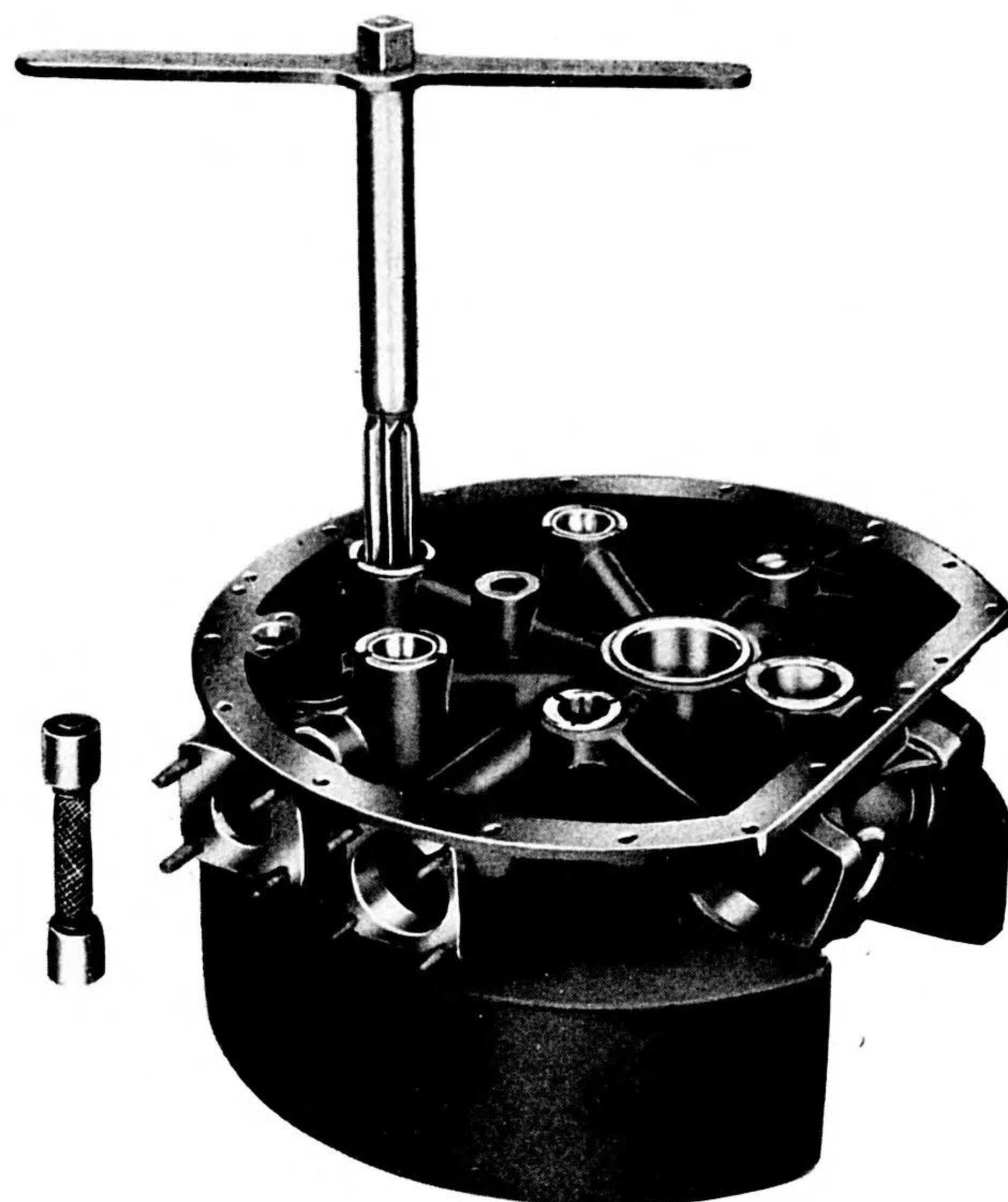
3331 後方蓋軸受筒の修正
